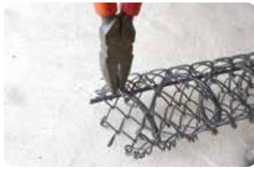
2 カットした部分をペンチで元のように曲げ戻します。
