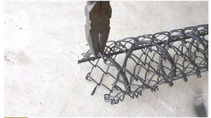
**2** カットした部分をペンチで元のように曲げ戻します。
