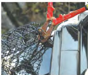
**6** 「ゆきもちくん(S)」の場合、コイル、5mm鋼線もカットします。※「ゆきもちくんデルタ」「スーパーデルタ」「ビッグエル280」の場合は定尺でのご利用を推奨します。
