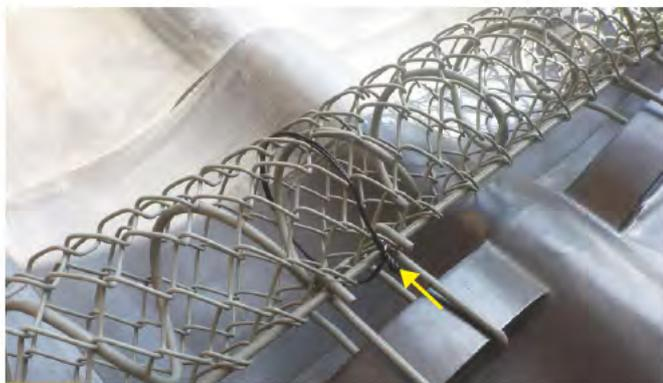
**5** 製品取付け後、取付部品との結合部に緩みがある等スーパーリングが外れる恐れがある場合には、1mに1箇所程度の間隔で取付部品とスーパーリングを結束し補強をしてください。(写真：A-1を用いた場合の例)
